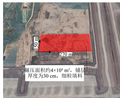
图 5 碾压区示意 Fig.5 Schematic diagram of rolling area
